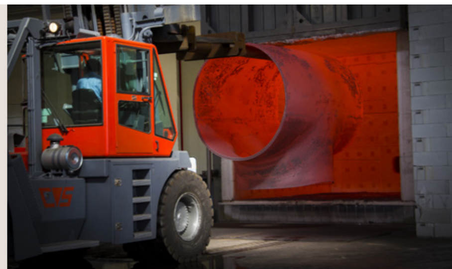
Ingresso in fornace di un raccordo a T di grandi dimensioni
