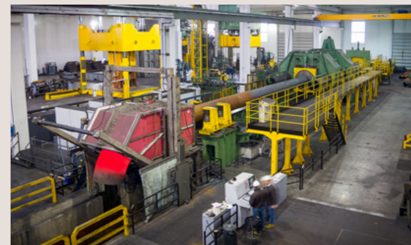
La macchina mandrino a induzione di grandi dimensioni nello stabilimento di Castel San Giovanni, unica in Europa con i suoi 66,5 metri di lunghezza, 7 di larghezza, capace di curvare tubi lunghi 13 m e di produrre curve fino a 56° con una capacità produttiva di 11,5 tonnellate/ora
